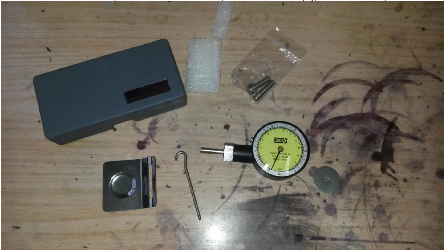
Penetrometru (pentru masurarea fermitatii) alimentelor solide (legume, fructe, etc...)
